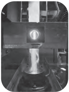
竜巻のように 旋回しながら 二酸化炭素を 分解している 青いプラズマ
